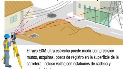
El rayo EDM ultra estrecho puede medir con precisión muros, esquinas, pozos de registro en la superficie de la carretera, incluso vallas con eslabones de cadena y ramas de árboles.
