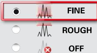
Elija la sensibilidad de la nivelación que se necesita para algunas funciones de medición. FINE significa que la nivelación del dispositivo es sensible a cualquier pequeña vibración. Elija ROUGH para trabajar en entornos de construcción duros con muchos choques y vibraciones. En este caso, la precisión se reduce en correlación con los movimientos.
